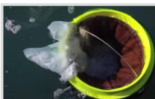
Aspiration des déchets flottants et hydrocarbures
